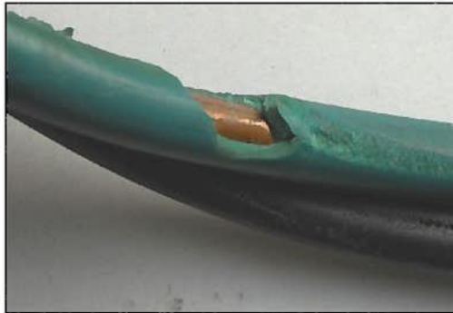
【写真2】飛来物等により外傷が発生した例 (1999年製)
